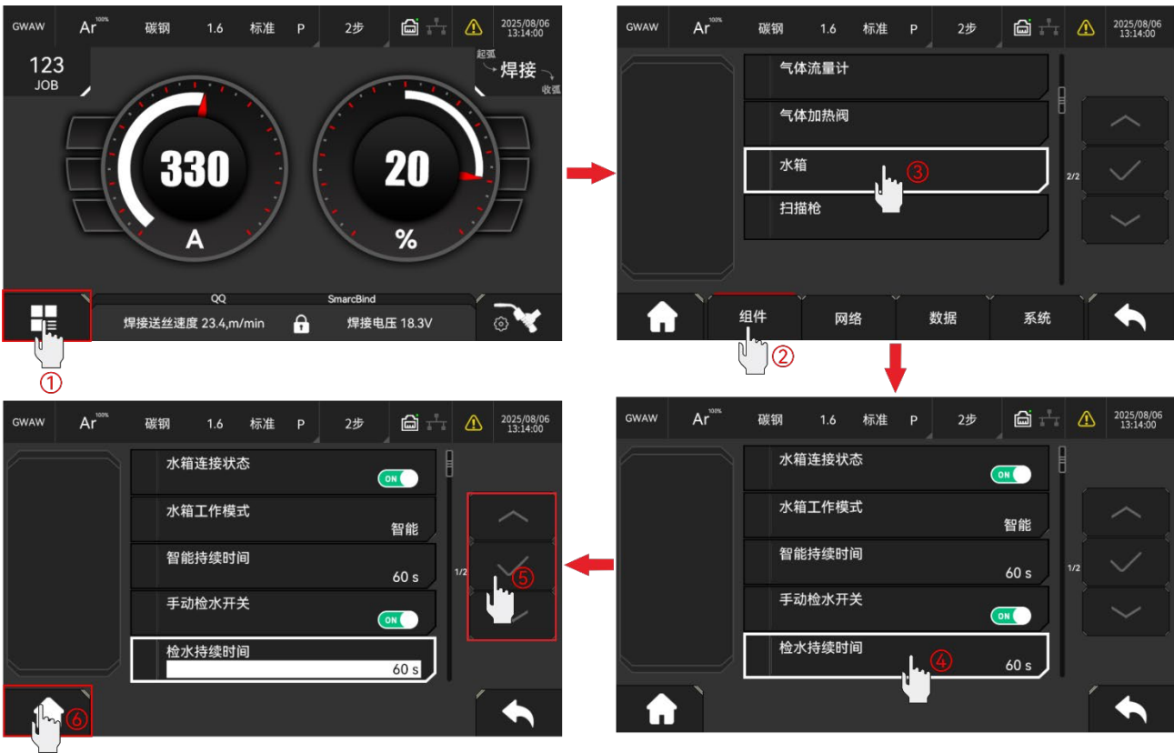
图3-5 检水持续时间操作步骤图
